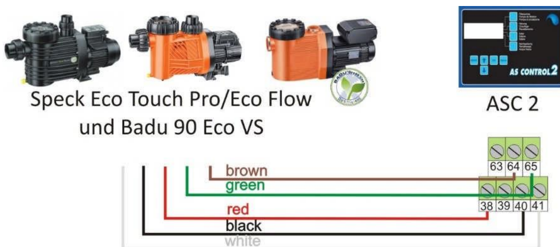
Figur 14. Tilslutning af Speck Eco Touch Pro og Badu 90 Eco VS
