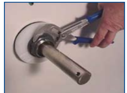
Tighten check nut.
